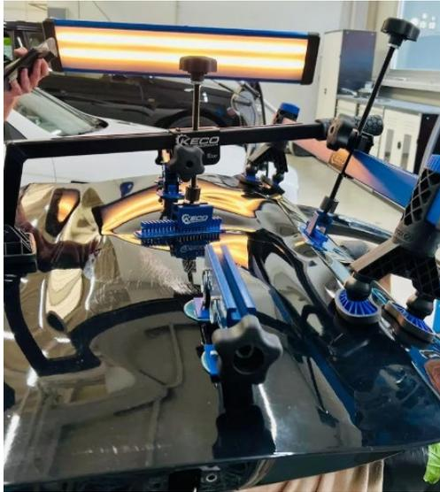
**Légende de la photo:** Même les grosses bosses peuvent être éliminées avec la méthode Glue Pull Repair (GPR) et la méthode Paintless Dent Repair (réparation de bosses sans peinture).
