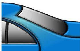
Lustrer la zone de raccord avec un produit de polissage gros et essuyer tous les résidus. Poncer la transition vers la zone endommagée avec par ex. un Disque de Finition 3M Trizact P3000 Fin ou un abrasif similaire d'autres fabricants. Nettoyer suffisamment la zone poncée et la zone lustrée avec Standox Nettoyant 6800.
