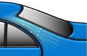
Beispritzen des puren Performance Blend 5730 in dünnen Spritzgängen auf die polierte Bleilackierzone (bei Verwendung der Spritzpistole, Druck reduzieren).
