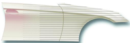
Poncer légèrement l'élément du raccord au tampon gris pour enlever le brouillard de pulvérisation, si nécessaire. Appliquer Stadox Basecoat Colourless sur l'élément adjacent si désiré. Appliquer la première couche de teinte d'effet sur la teinte de fond et dégrader sur le bord de la couche de fond précédemment appliquée dans l'élément adjacent. Utiliser la technique gouttelette pour réaliser le raccord. Désolwater.
