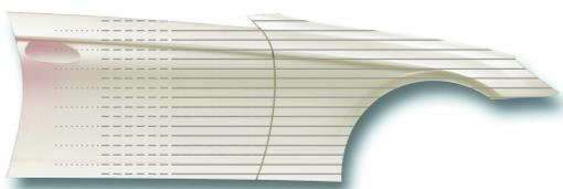
Appliquer la seconde couche de la couche d'effet et fondre sur le bord de la couche précédente dans l'élément adjacent. Utiliser la technique gouttelette pour raccorder à pression réduite.
