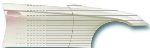
Applicare la seconda mano della mano ad effetto e sfumare sui bordi della mano precedente nel pannello adiacente. Usare la tecnica a goccioline per sfumare con pressione ridotta.
