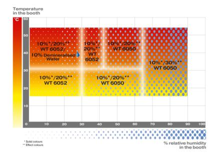
30% d'Additif WT 6050 peut être ajouté lorsque l'humidité relative dépasse 65%, seulement pour les teintes Métallisées et Nacrées
