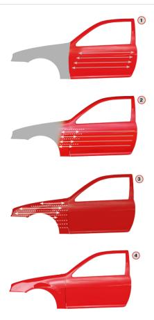
Commencer par appliquer 1 - 2 couches fermées de Permahyd Additif Raccordeur 1050 / 1051\* sur la zone de raccord. S'assurer que la zone de raccord est suffisamment grande. Ne pas laisser désolvater le Permahyd Additif Raccordeur 1050 / 1051.\*\*
