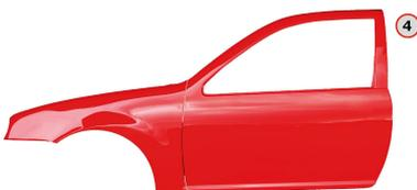
Dopo l'appassimento, applicare sull'intera zona di riparazione il trasparente Permasolid HS.
