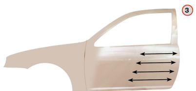
3 Dopo l'appassimento fino ad opacizzazione, applicare una mano chiusa di Permahyd Blend-in Additive 1050/1051 puro (senza catalizzatore) sulla zona di sfumatura.
