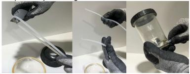
7) Fixez le godet à la buse du pistolet de pulvérisation Performance avant d'inverser le godet
