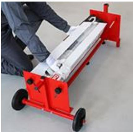
5. Schieben Sie die Oberseite (mit dem Handgriff) gegen den Karton. Ziehen Sie die schwarzen Knöpfe der Oberseite an der mittleren Stange fest, um die Oberseite zu fixieren.
