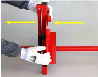
3. Lösen Sie die schwarzen Knöpfe auf der Unterseite bei den Rädern. Schieben Sie die „roten Halter“ so weit wie möglich heraus. Ziehen Sie die schwarzen Knöpfe fest, sodass die „roten Halter“ aufrecht bleiben.
