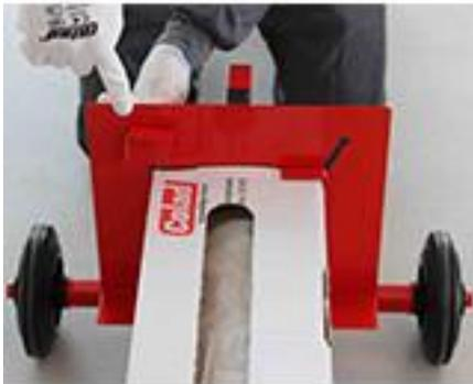
4. Legen Sie den Karton seitlich des Spenders an. Setzen Sie ihn so nah wie möglich an die Unterseite (die Räder).
